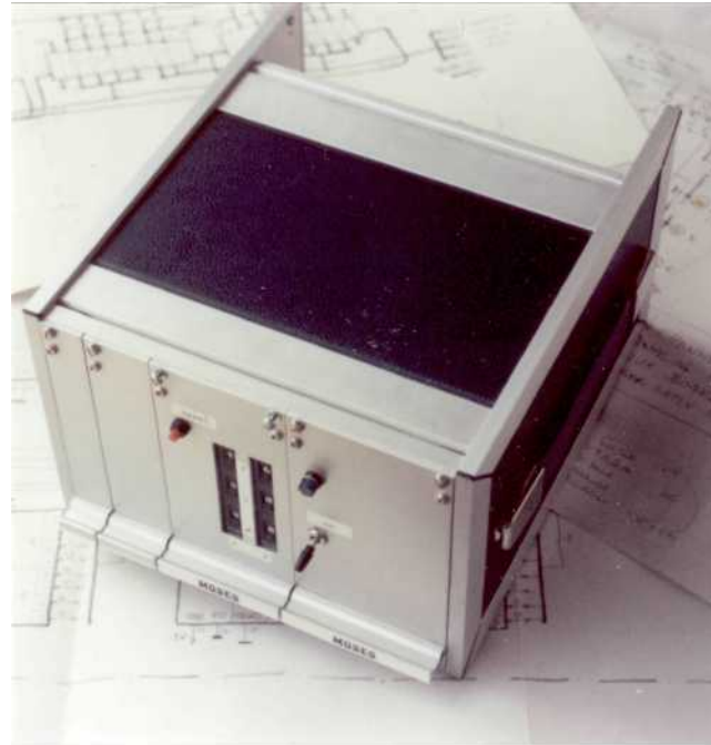
Digitalrechner für analoge 20-mA-Prozeßsignale von MOSES Dipl.-Ing. Michael M. Iloff
